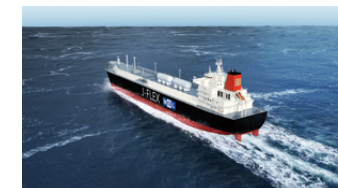
アンモニアを燃料としたアンモニア輸送船 (J-FLEX) のイメージ
