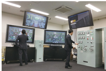
実機の操縦装置を配した機関シミュレータ
