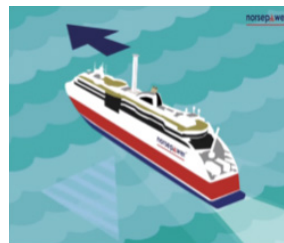
ローターセイルの揚力により、前進方向へ推力を得る
