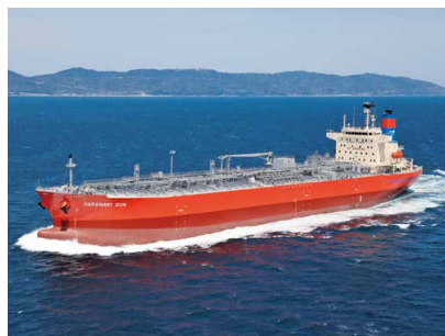
メタノールを燃料とするメインエンジンを搭載した 世界初のメタノール運搬船
