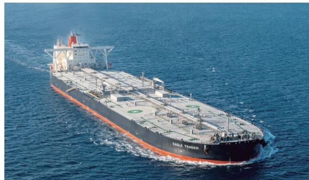
原油や石油精製品、化学品などの液体貨物を運ぶ船です。商船三井には20万重量トン以上の大型原油タンカーをはじめ、ケミカルタンカーやメタノールタンカーなど、輸送する液体貨物に対応した船隊が充実しています。時には、洋上の石油の備蓄基地としても活用されています。
