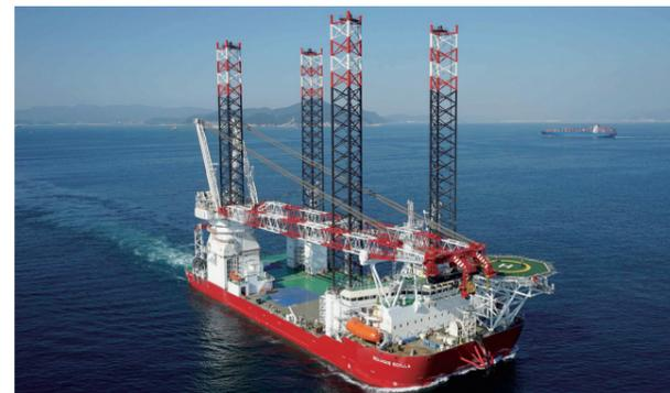
セップとは「Self-Elevating Platform」の略で、日本語では洋上風力発電設備設置船とよばれるものです。洋上風力発電に必要な風車タービンなどを海の上で設置できる船です。船体を海面より上の高さに持ち上げられる昇降可能な脚を持ち、風や波による、ゆれに影響されない安全で確実な作業を行うことができます。
