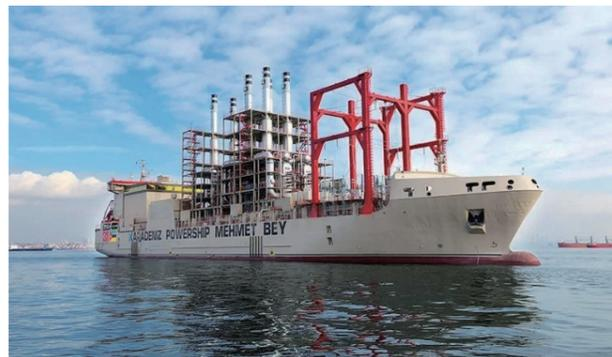
船の上に発電設備を搭載し、洋上を移動する発電所の役割をするのが発電船です。世界中あらゆる場所へ海上を移動し、さまざまな電力ニーズに対応できることから、未来の電力供給方法として注目をあつめています。現在では、重油に比べCO<sub>2</sub>の排出が少ない天然ガスを使って発電するため、液化天然ガス(LNG)を運ぶLNG船から洋上でLNGを供給する場合があります。
