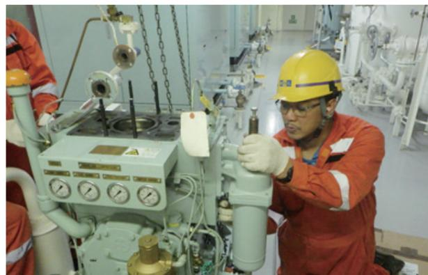
主機（メインエンジン）・補機はもちろん、航海にかかせない電気、水、蒸気などの多種多様な機器について知りつくし、たえず正常に機能するように監視とメンテナンスを行っています。
