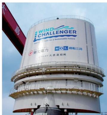
商船に積載できる貨物量に影響を及ぼさないためには、帆をいかに軽量化できるかが重要です。そのため、帆の素材にはGFRP（ガラス繊維強化プラスチック）という素材を採用しています。
