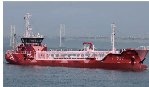
世界初の電気で動くタンカーです。動力源として3,480kWhの大容量リチウムイオン電池を搭載、完全ゼロエミッションを実現します。
