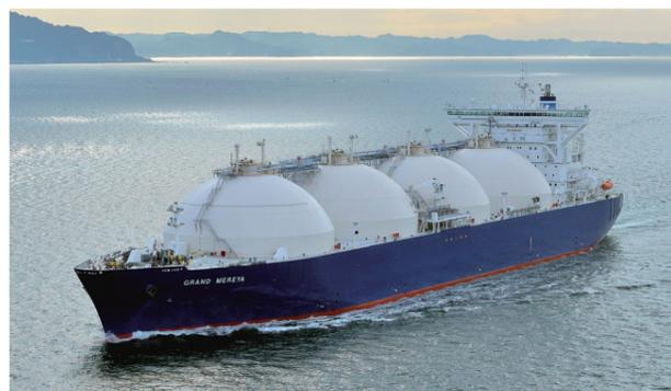
液化天然ガス(LNG)を運ぶタンカーです。マイナス161.5度で液化する天然ガスを輸送するための超低温に耐える特殊な材質のタンクや、安全にLNGを積み降ろしするための高度な技術が使われています。また、タンクの中で気化したガスは、船の燃料としても利用されています。
