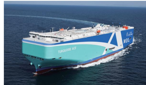
自動車や建設機械など、自走できる貨物をそのまま運転して積み込み、輸送できる船です。船内は立体駐車場のよう、何層ものデッキ構造になっています。船の大きさによっては、6,800台もの自動車を一度に輸送可能です。
