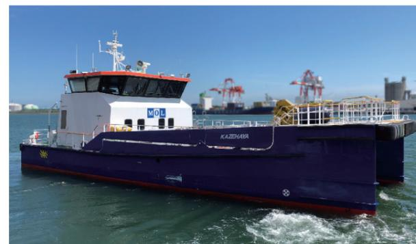
エスオーブイ SOV船が、陸から遠く離れた洋上風力発電に利用される一方で、比較的陸から距離が近い場所に建設されている洋上風力発電への、メンテナンス技術者派遣に使用されるのが、CTV(Crew Transfer Vessel)船です。拠点となる港から、12~24人程度の技術者を送迎できる交通船の役割を果たします。フェンダーと呼ばれる防舷物を船首に取り付け、風車に押し付ける形で船体を安定させてから、技術者を風車へわたせるようになっています。
