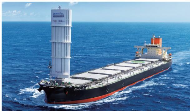
クリーンな再生可能エネルギーである風力を、船舶の推進力にかえようというプロジェクトです。最新技術で現代に帆船をよみがえらせ、大型貨物船の燃料消費と温室効果ガス排出量の大幅削減を目指します。
