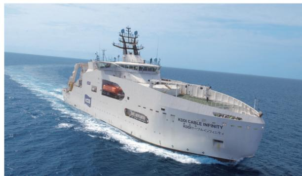
海底に光通信や電力ケーブルの敷設や修理、回収を行う船です。海底ケーブルを安全・正確に敷設するために、波や風で動く船を一定の位置にとどめるダイナミックポジションシステムが搭載されています。みなさんが普段使っているインターネットの安定通信など、デジタル時代を支える大事な船です。
