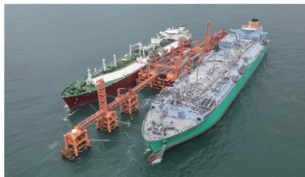
浮体式LNG貯蔵再ガス化設備(Floating Storage and Regasification Unit)といわれるものです。洋上のLNG受入基地として、LNGを受入、貯蔵、再ガス化までを行います。陸に設備を作る必要がなく、必要な場所に基地ごと移動できるのが特徴です。
