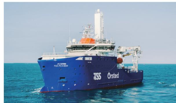
エスオーブイ SOVとは「Service Operation Vessel」とよばれる船で、陸から遠くに設置されている洋上の風車や発電所をメンテナンスするための技術者を送るための船です。作業時間によっては、すぐに陸に帰れないため、泊まる部屋や食事を提供する食堂、ジムなどを備えています。また、海の上の風車に技術者を安全にわたすための自動船位保持や波などによる船体動揺を吸収する機能を搭載しています。
