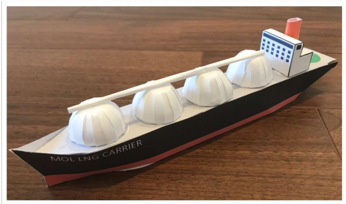
LNG（エルエヌジー）とは、Liquefied Natural Gas（液化天然ガス）の略で、天然ガスの主成分であるメタンをマイナス162度まで冷却し液体にしたものです。液化すると、気体の時に比べ容積が600分の1になり、一度に大量の天然ガスを海上輸送できるようになります。
