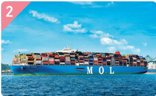
20,000TEU型コンテナ船。全長400m、全幅58.8m
