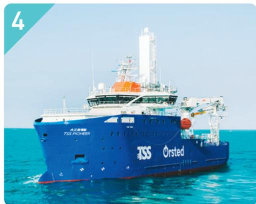
4 洋上風力発電所のメンテナンス技術者を複数の洋上風車に派遣するために多数の宿泊設備を持ち、一定期間洋上での活動が可能なオフショア支援船です。本船と洋上風車の距離を常時安全に保つため、ダイナミックポジショニングシステム (DPS:自動船位保持機能装置) を搭載、また本船から洋上風車プラットフォーム上に技術者を安全に渡すため、波等による船体動揺を吸収するモーション・コンペイセーション (Motion Compensation) 機能をもつ特殊なギャングウェイ (Gangway) も搭載しています。
