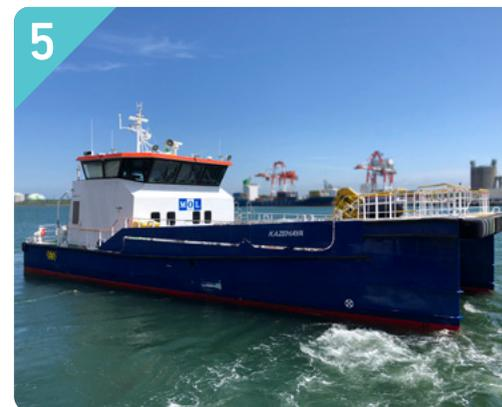
5 比較的離岸距離の近い洋上風車に対して、洋上風力発電所のメンテナンス技術者を、拠点となる港から送り届ける交通船 (乗客定員12-24人)。船首部分に取り付けられたフェンダーを洋上風車に押し付ける形で船体を安定させ、メンテナンス技術者が洋上風車に移乗します。アルミ製の双胴船 (Catamaran) が主流船型です。
