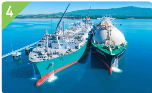
浮体式LNG貯蔵再ガス化設備 (FSRU)
