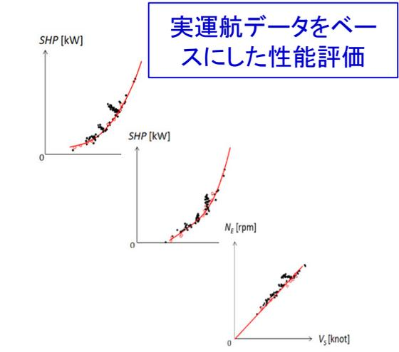
実船モニタリングデータと平水中主機出力-船速・回転数関係
