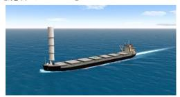
※ 伸縮可能な帆(硬翼帆)によって、風力エネルギーを推進力に変換する装置で、本装置を船舶に搭載することにより、航行燃料の削減が可能となるため、環境負荷の低減と経済性の向上に寄与する。
