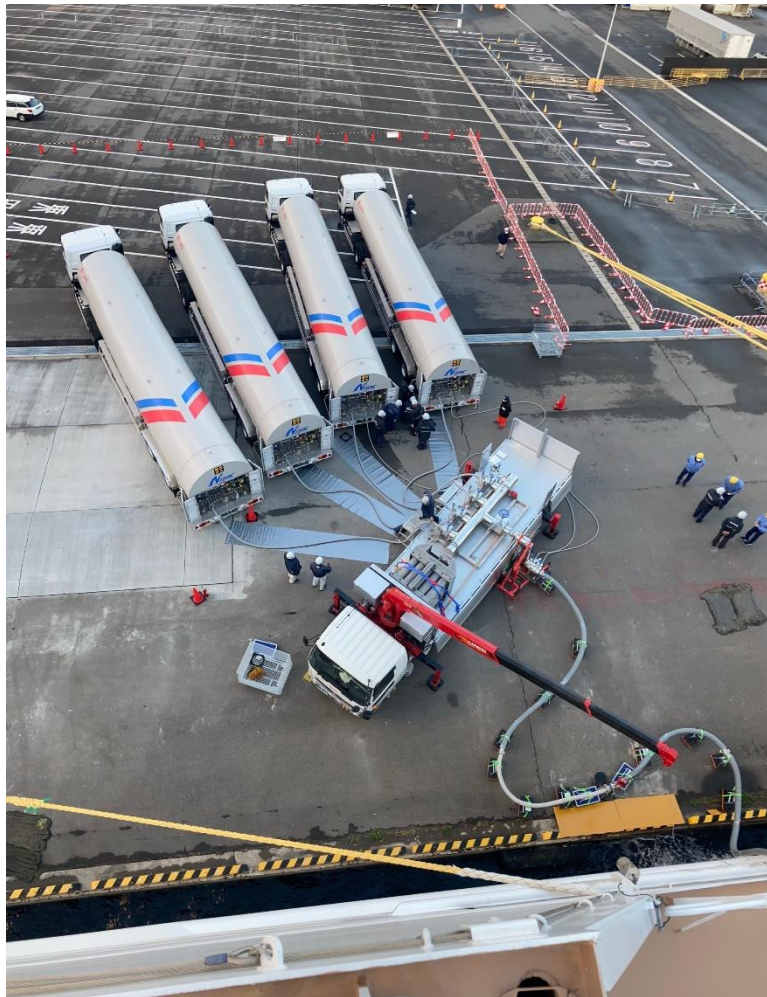
タンクローリー4台とスキッドによるLNG燃料供給の様子
