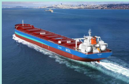
アンモニア二元燃料 ケープサイズバルカー (2026年度竣工予定)
