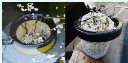
Seabinによる海洋プラスチック回収(広島港)
