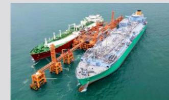
LNG船（左）からLNGを受け入れ、FSRU「MOL FSRU Challenger」（右）
