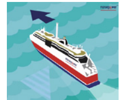
ローターセイルの揚力により、前進方向へ推力を得る
