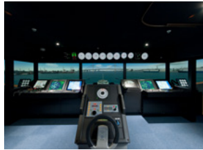
全方位視野に対応した操船シミュレータ
