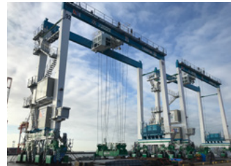
神戸国際コンテナターミナル、横浜港の南本牧ふ頭コンテナターミナルに導入済のニアゼロエミッション型トランステーナ® (写真：横浜港の南本牧ふ頭)
