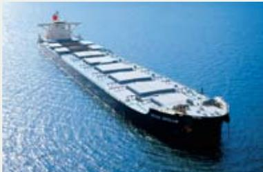
ドライバルク船では、乾貨物を梱包せずじばらのままで大量に輸送しています。大型化が進む鉄鉱石船、積揚港の規模に合わせて設計された石炭船、比重の軽い木材チップを運ぶチップ船、穀物等を運ぶ一般不定期船等により輸送した貨物は、様々な製品の原材料や燃料として、また、食料や家畜の飼料として使用されます。更には、産業の成長に不可欠な大型機械やプラント資材等、通常の貨物船では運ぶことのできない重さや大きさの貨物を運ぶ重量物船も運航しています。
