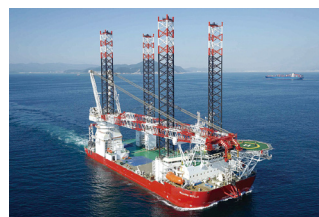
発電設備設置 (SEP船)
